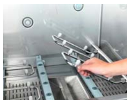
Spodní oplachovací vedení zaklapněte nahoru
