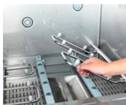
Spodní oplachovací vedení zaklapněte nahoru
