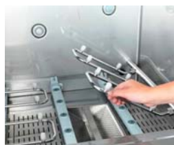
Spodní oplachovací vedení zaklapněte dolů
